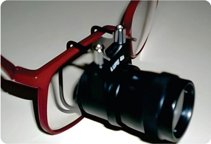
IMAGEM 8. Sistema telemicroscópico para perto, com foco ajustável e montado sobre a correção para longe. Fonte: Refratometria Ocular e Visão Subnormal. Série Oftalmologia Brasileira Digital, Conselho Brasileiro de Oftalmologia. Página 494.
