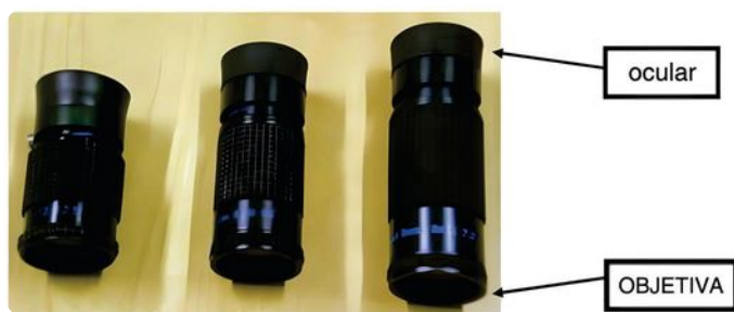
IMAGEM 9. Sistema telemicroscópico para perto, com foco ajustável e montado sobre a correção para longe. Fonte: Refratiometria Ocular e Visão Subnormal. Série Oftalmologia Brasileira Digital, Conselho Brasileiro de Oftalmologia. Página 494.
