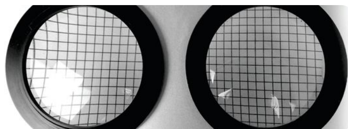
FIGURA 2. Lente esférica à esquerda e asférica à direita. Fonte: https://lenscope.com.br/blog/lentes-asfericas-ou-esfericas-como-ter-lentes-mais-finas/
